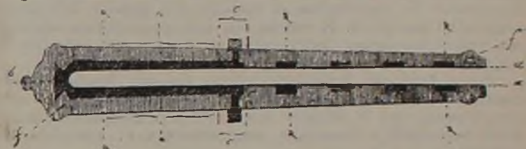
Sezioni longitudinale dell'artiglieria leggera secondo il manoscritto di Marino Marini.
